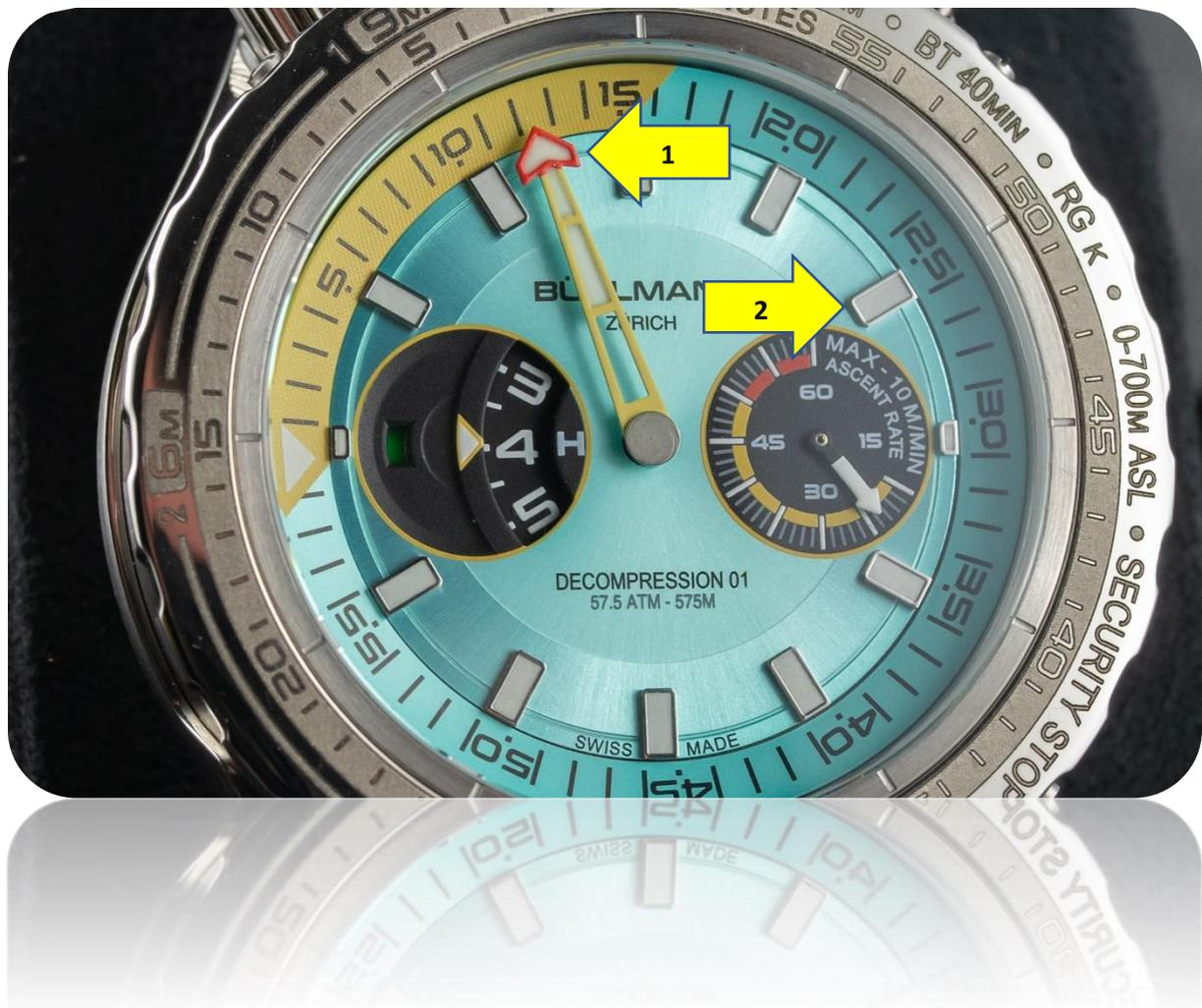
Auf der rechten Seite des Ziffernblattes, bei 3 Uhr (15 Uhr) ist eine Sekundenskala (1). Sie dient als Sekundenanzeige und als Aufstiegshilfe.
