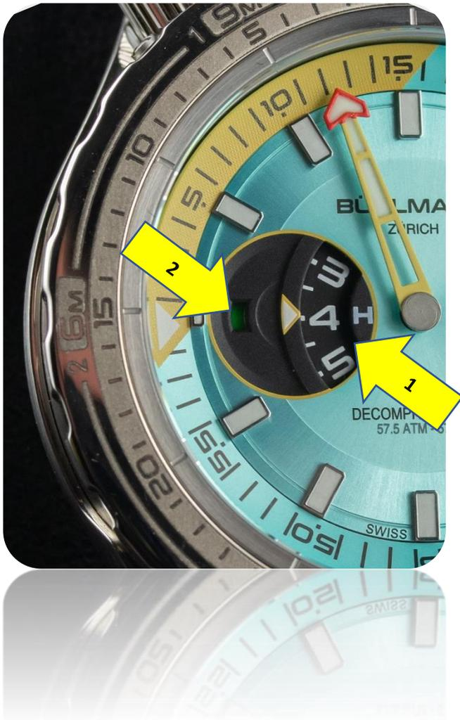
Die kleine farbige Skala ist der Flugindikator (2). Dieser Indikator zeigt an, ab wann der Taucher nach dem Tauchgang wieder mit dem Flugzeug fliegen kann.
