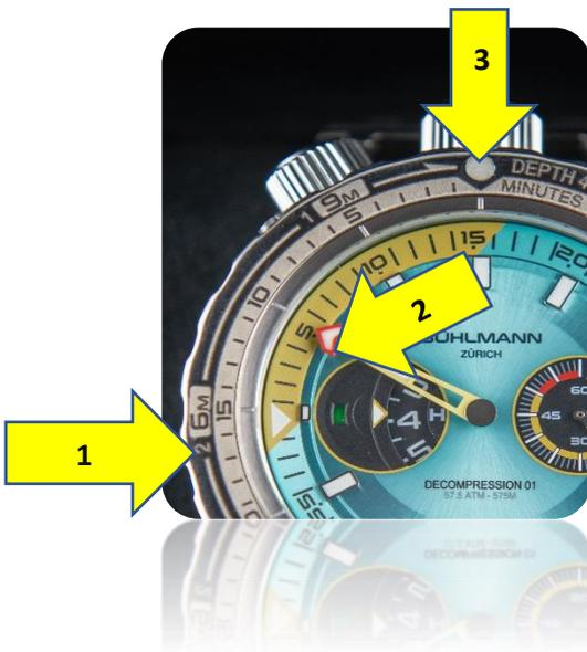
In der zweiten Tiefe angekommen dreht man die Lünette so, dass der zweite Dekompressions Stop (Security Stop 2) (1) in der Mitte des Minutenzeigers (2) steht. Auch in der Tiefe wartet man, bis der Minutenzeiger den Leuchtpunkt (3) auf der Lünette erreicht hat.
